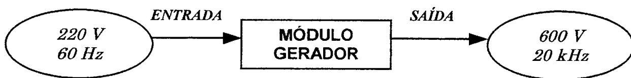
Figura 2.2 – Esquema da mudança de voltagem e frequência da energia elétrica num módulo gerador.
